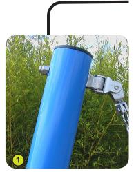
1- Die Standpfosten sind aus feuerverzinktem und pulverbeschichtetem Stahl, Ø 114,3 mm, 4 mm Wandstärke und einer Länge von 1,45 m, mit einer Abdeckkappe aus Kunststoff.
