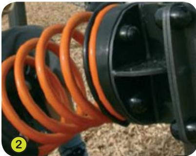
**2- Die Federn** sind aus Stahl 35 SCD 6. Die Oberflächen sind nach dem Sandstrahlen vorgespannt und mit einer Zinkgrundierung sowie zwei Schichten Epoxidharzpulver von 100 Mikron versehen. Die Halterung (Proludic-Patent) ist aus Polyamid. Dadurch ist das System langlebig und außergewöhnlich sicher.
