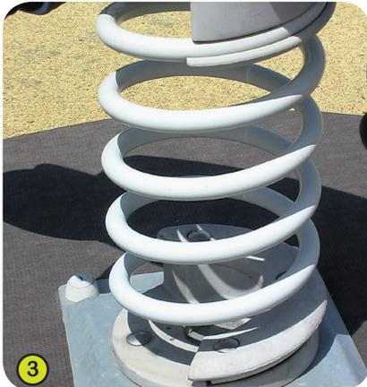
3- **Die Feder** ist aus Stahl 35 SCD 6. Die Oberfläche ist nach dem Sandstrahlen vorgespannt und mit einer Zinkgrundierung sowie zwei Schichten Epoxidharzpulver von 100 Mikron versehen. Die Halterung (Proludic-Patent) ist aus Polyamid. Dadurch ist das System langlebig und außergewöhnlich sicher.
