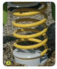
3- **Die Federn** sind aus Stahl 35 SCD 6. Die Oberflächen sind nach dem Sandstrahlen vorgespannt und mit einer Zinkgrundierung sowie zwei Schichten Epoxidharzpulver von 100 Mikron versehen. Die Halterung (Proludic-Patent) ist aus Polyamid. Dadurch ist das System langlebig und außergewöhnlich sicher.
