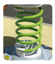
2- **Die Federn** sind aus Stahl 35 SCD 6. Die Oberflächen sind nach dem Sandstrahlen vorgespannt und mit einer Zinkgrundierung sowie zwei Schichten Epoxidharzpulver von 100 Mikron versehen. Die Halterung (Proludic-Patent) ist aus Polyamid. Dadurch ist das System langlebig und außergewöhnlich sicher.
