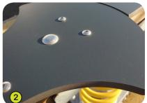
2- Die Sitze sind aus Trespa-Harzkompositplatten, 13 mm stark. Sie werden auf Basis thermohärtender Harze (30%) hergestellt, homogen verstärkt mit Holzfasern (70%), die unter hohem Druck und Temperatur verpresst werden, und dadurch besonders unempfindlich gegenüber allen Wettereinflüssen sind.
