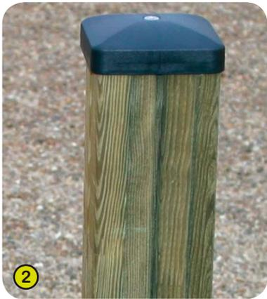
2- **Die 95 mm dicken Vierkantpfosten** sind aus chrom- und arsenfrei kesseldruck-impregniertem Kieferleimbinder. Das Leimholz ist splitterfrei, sehr solid und formbeständig. Die Pfosten sind gegen Pilz-, Insekten- und Termitenbefall geschützt.
