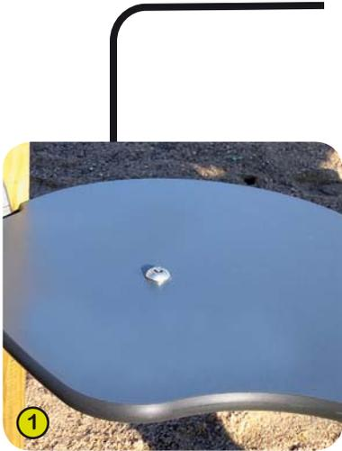
1- **Die Spieltische, Plattformen und farbigen Harzkomposit-Platten** sind aus einem kompakten, 13 mm dicken Kompaktwerkstoff gefertigt. Dieser besteht aus 70% Weichholzfasern und 30% wärmegehärtetem Kunstharz und ist extrem witterungsbeständig. Die eingefärbten Oberflächen sind mit pigmentiertem Acrylpolyurethanharz behandelt. Dadurch sind sie gut UV- und witterungsbeständig.
