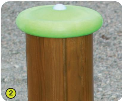
2- **Die 125 mm dicken Rundpfosten** sind aus chrom- und arsenfrei kesseldruck-impregniertem Kieferleimbindler. Das Leimholz ist splitterfrei, sehr solid und formbeständig. Die Pfosten sind gegen Pilz-, Insekten- und Termitenbefall geschützt. Schutzkappen aus Polyamid an den Pfostenspitzen verhindern das Eintreten von Regenwasser.
