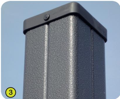
3- **Die Standpfosten für den Turm** sind aus beschichtetem, verzinktem Stahl, 95 x 95 mm. Die in zwei verschiedenen Grautönen hammerschlaglackierte Oberfläche hat ein leichtes Profil und ist so weitgehend unempfindlich gegen Kratzer. Die Schutzkappen sind aus Polyamid.
