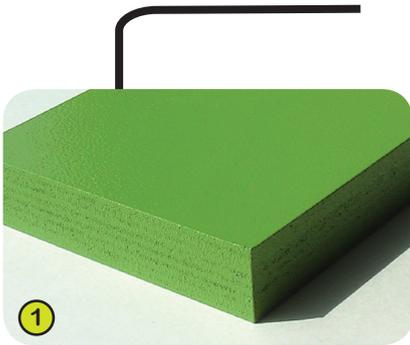
1- **Die lackierten Platten** sind aus hochwertigen, 22 mm starken, alternierend verleimten Birkenholzpaneelen. Die Schichtholzplatten werden mit schwermetallfreien Zweikomponenten Polyurethan-Pulverlacken elektrostatisch beschichtet. Dadurch sind die Platten gegen Umwelteinflüsse oder auch aggressive chemische Reinigungsmittel, wie z.B. Anti-Graffiti-Substanzen und UV-Strahlung ausserordentlich widerstandsfähig.
