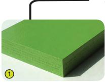
1- Die lackierten Platten sind aus hochwertigen, 22 mm starken, alternierend verleimten Birkenholzpaneelen. Die Schichtholzplatten werden mit schwermetallfreien Zweikomponenten Polyurethan-Pulverlacken elektrostatisch beschichtet. Dadurch sind die Platten gegen Umwelteinflüsse oder auch aggressive chemische Reinigungsmittel, wie z.B. Anti-Graffiti-Substanzen und UV-Strahlung ausserordentlich widerstandsfähig.
