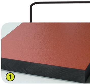
1- **Die farbigen Platten** bestehen aus Trespa-Harzkompositplatten, 13 mm stark. Sie werden auf Basis thermohärtender Harze (30%) hergestellt, homogen verstärkt mit Holzfasern (70%), die unter hohem Druck und Temperatur verpresst werden, und dadurch besonders unempfindlich gegenüber allen Wiedereinflüssen wie z. B. Sonne, Regen, Feuchtigkeit, ... (klimatische Aggressionen) sind.
