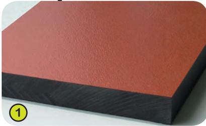
1- **Die farbigen Platten** bestehen aus Trespa-Harzkompositplatten, 13 mm stark. Sie werden auf Basis thermohärtender Harze (30%) hergestellt, homogen verstärkt mit Holzfasern (70%), die unter hohem Druck und Temperatur verpresst werden, und dadurch besonders unempfindlich gegenüber allen Witterungseinflüssen wie z. B. Sonne, Regen, Feuchtigkeit, ... (klimatische Aggressionen) sind.
