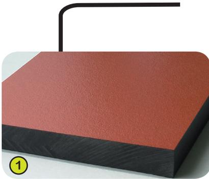
1- **Die farbigen Platten** bestehen aus Trespa-Harzkompositplatten, 13 mm stark. Sie werden auf Basis thermohärtender Harze (30%) hergestellt, homogen verstärkt mit Holzfasern (70%), die unter hohem Druck und Temperatur verpresst werden, und dadurch besonders unempfindlich gegenüber allen Wiedereinflüssen wie z. B. Sonne, Regen, Feuchtigkeit, ... (klimatische Aggressionen) sind.
