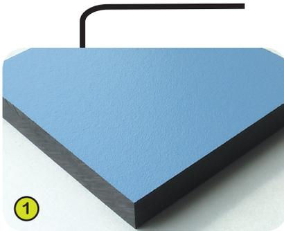
1- **Die farbigen Platten** bestehen aus Trespa-Harzkompositplatten, 13 mm stark. Sie werden auf Basis thermohärtender Harze (30%) hergestellt, homogen verstärkt mit Holzfasern (70%), die unter hohem Druck und Temperatur verpresst werden, und dadurch besonders unempfindlich gegenüber allen Wittereinflüssen wie z. B. Sonne, Regen, Feuchtigkeit, ... (klimatische Aggressionen) sind.
