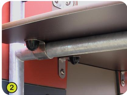
2- **Die Standflächen der Plattformen** sind aus 12,5 mm starken, an der Oberfläche rutschfest strukturierten, Harzkompositplatten (HPL), verstärkt durch Unterzüge aus Stahl.
