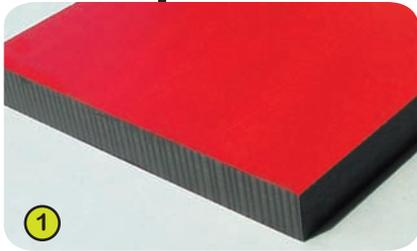
1- **Die farbigen Platten** bestehen aus Trespa-Harzkompositplatten, 13 mm stark (HPL). Temperatur- und witterungsbeständig, widerstandsfähig gegen Vandalismus.
