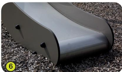
6- **Die Rutschflächen** sind aus 2 mm dickem Edelstahlblech, aus einem Stück gefertigt, gekantet und gebogen.
