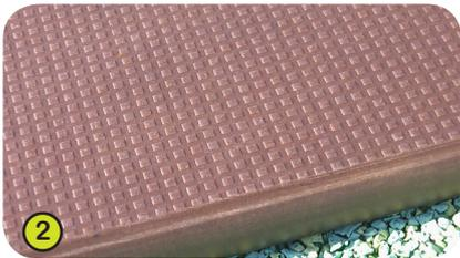
2- **Die Standflächen der Plattformen und die Kletterrampen** sind aus 12,5 mm starken, an der Oberfläche rutschfest strukturierten, Harzkompositplatten (HPL), verstärkt durch Unterzüge aus Stahl.
