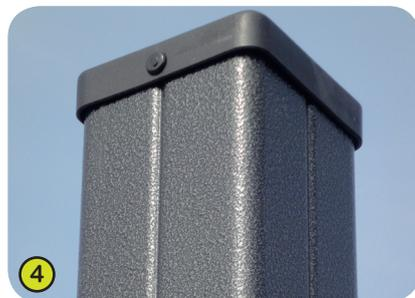
4- **Die 95 mm dicken Vierkantpfosten** sind aus verzinktem und lackiertem Stahl, garantiert langlebig und widerstandsfähig. Die Schutzkappen sind aus Polyamidspritzguss.
