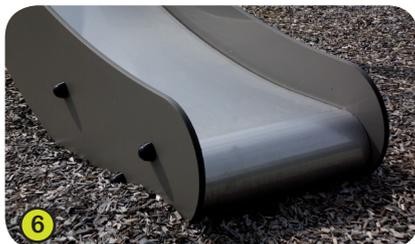
6- **Die Rutschflächen** sind aus 2 mm dickem Edelstahlblech, aus einem Stück gefertigt, gekantet und gebogen.
