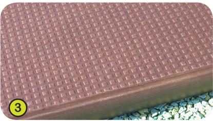
3- **Die Standflächen der Plattformen** sind aus 12,5 mm starken, an der Oberfläche rutschfest strukturierten, Harzkompositplatten (HPL), verstärkt durch Unterzüge aus Stahl.
