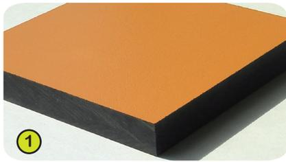
1- **Die farbigen Platten** bestehen aus Trespa-Harzkompositplatten, 13 mm stark (HPL). Temperatur- und witterungsbeständig, widerstandsfähig gegen Vandalismus.
