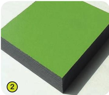
2- **Die farbigen Platten** bestehen aus Trespa-Harzkompositplatten, 13 mm stark. Sie werden auf Basis thermohärtender Harze (30%) hergestellt, homogen verstärkt mit Holzfasern (70%), die unter hohem Druck und Temperatur verpresst werden, und dadurch besonders unempfindlich gegenüber allen Witterungseinflüssen wie z. B. Sonne, Regen, Feuchtigkeit, ... (klimatische Aggressionen) sind.
