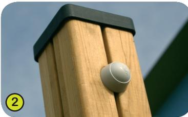
2- **Die 95 mm dicken Vierkantpfosten** sind aus chrom- und arsenfrei kesseldruckimprägniertem Kieferleimbinder. Das Leimholz ist splitterfrei, sehr solid und formbeständig. Die Pfosten sind gegen Pilz-, Insekten- und Termitenbefall geschützt.
