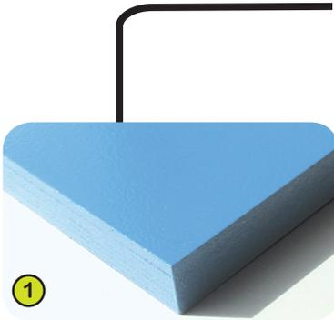
1- **Die lackierten Platten** sind aus hochwertigen, 22 mm starken, alternierend verleimten Birkenholzpaneelen. Dadurch sind sie besonders haltbar und besonders schlagfest. Die Schichtholzplatten werden mit schwermetalldfreien Zweikomponenten Polyurethan-Pulverlacken elektrostatisch beschichtet. Dadurch sind die Platten gegen Umwelteinflüsse oder auch aggressive chemische Reinigungsmittel, wie z.B. Anti-Graffiti-Substanzen und UV-Strahlung ausserordentlich widerstandsfähig.
