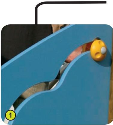
1- **Die lackierten Platten** sind aus hochwertigen, 21 mm starken, alternierend verleimten Birkenholzpaneelen. Dadurch sind sie besonders haltbar und besonders schlagfest. Die Schichtholzplatten werden mit schwermetalldfreien Zweikomponenten Polyurethan-Pulverlacken elektrostatisch beschichtet. Dadurch sind die Platten gegen Umwelteinflüsse oder auch aggressive chemische Reinigungsmittel, wie z.B. Anti-Graffiti-Substanzen und UV-Strahlung ausserordentlich widerstandsfähig.
