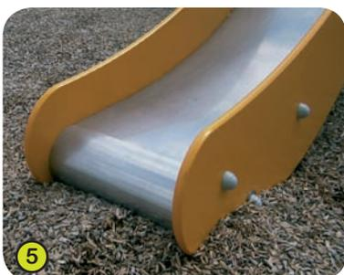
5- **Die Rutschflächen der Rutschen** sind aus 2 mm dickem Edelstahlblech, aus einem Stück gefertigt, gekantet und gebogen.
