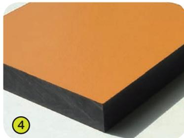
4- **Informationstafeln** bestehen aus Trespa-Harzkompositplatten, 13 mm stark. Sie werden auf Basis thermohärtender Harze (30%) hergestellt, homogen verstärkt mit Holzfasern (70%), die unter hohem Druck und Temperatur verpresst werden, und dadurch besonders unempfindlich gegenüber allen Witterungseinflüssen wie z. B. Sonne, Regen, Feuchtigkeit, ... (klimatische Aggressionen) sind.
