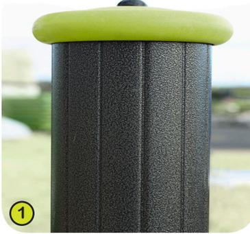
1- **Die Standpfosten** mit 125 mm Durchmesser sind aus verzinktem, lackiertem Stahl. Die in zwei verschiedenen Grautönen hammerschlaglackierte Oberfläche hat ein leichtes Profil und ist so weitgehend unempfindlich gegen Kratzer. Die Schutzkappen sind aus Polyamidspritzguss.
