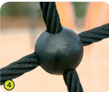
4- **Die Seile und Kletternetze** sind aus mit Polyester ummanteltem, verzinktem Stahldrahtseil. Die Knotenpunkte aus Polyamidspritzguss verbinden die Seile und sorgen für festen Halt.
