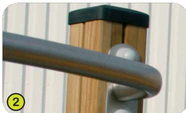
2- **Die 95 mm dicken Vierkantpfosten** sind aus chrom- und arsenfrei kesseldruckimprägniertem Kieferleimbinder. Das Leimholz ist splitterfrei, sehr solid und formbeständig. Die Pfosten sind gegen Pilz- und Insektenbefall geschützt.
