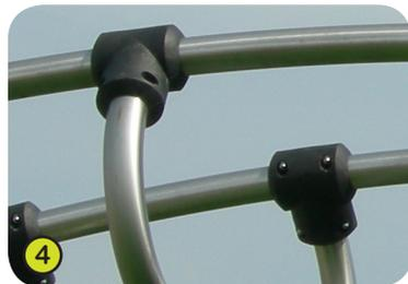
4- **Die Gestänge** sind aus Edelstahl, dm: 40 mm. Dadurch sind Langlebigkeit und ein angenehmes Erscheinungsbild der Spielgeräte über viele Jahre hinweg gewährleistet. **Die Verbindungsstücke** sind Gussteile aus nicht giftigem, schwer entflammbarem, schlagfestem und UV-beständigem Polyamid. Dadurch sind die Spielgeräte robust und weitgehend gegen Vandalismus geschützt.
