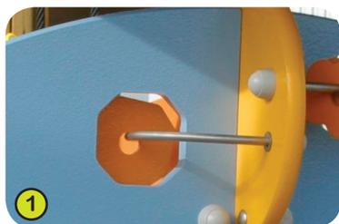
1- **Die lackierten Platten** sind aus hochwertigen, 22 mm starken, alternierend verleimten Birkenholzpaneelen. Dadurch sind sie besonders haltbar und besonders schlagfest. Die Schichtholzplatten werden mit schwermetallfreien Zweikomponenten Polyurethan-Pulverlacken elektrostatisch beschichtet. Dadurch sind die Platten gegen Umwelteinflüsse oder auch aggressive chemische Reinigungsmittel, wie z.B. Anti-Graffiti-Substanzen und UV-Strahlung ausserordentlich widerstandsfähig.
