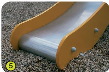
5- **Die Rutschflächen** sind aus 2 mm dickem Edelstahlblech, aus einem Stück gefertigt, gekantet und gebogen.
